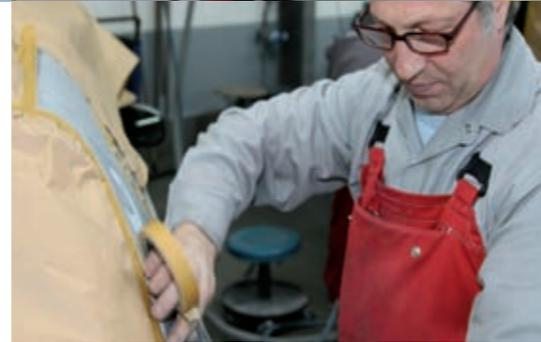
6) Das Abkleben findet vor dem Füllerauftrag und erneut vor dem Lackieren statt. Bei dieser Tätigkeit kommt es auf besondere Sorgfalt an, denn Farbnebel auf nicht zu lackierenden Flächen sowie scharfe Lackkanten müssen vermieden werden.
