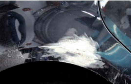
1) Instandgesetzte Karosserie, an diesem Punkt wird entschieden, ob der Bereich verzinkt wird oder dünn gespachtelt werden kann.
