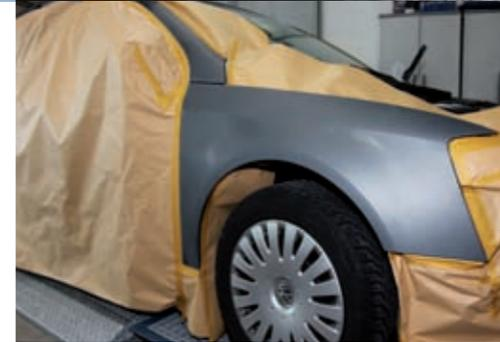
10) Angrenzende Bauteile werden bei Bedarf für die Farbangleichung vorbereitet.
