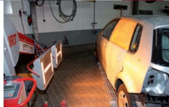
8) Füllertrocknung per Infrarot. Dies gewährleistet eine vollständige Durchtrocknung von unten nach oben und ist energiesparsamer als eine Lackierkabinentrocknung.
