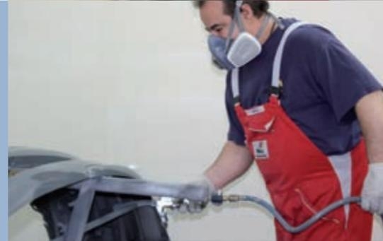
7) Der Füllerauftrag dient als Haftvermittler für den neuen Lack, zum Glätten von kleinsten Unebenheiten und Schleifkratzern. Er muss dick genug sein, um eine glatte Oberfläche zu ermöglichen, gleichzeitig soll aber auch eine möglichst dünne Gesamtmaterialestärke erreicht werden.
