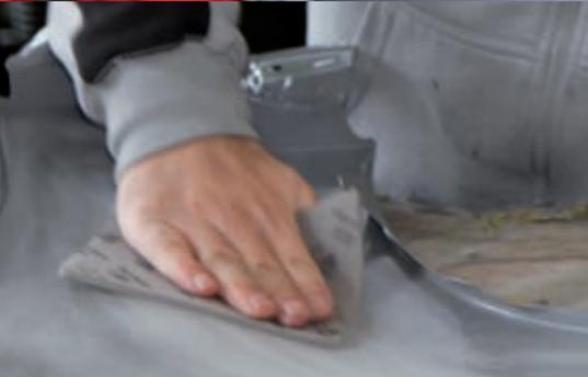
4) Neuteile müssen ebenfalls geschliffen werden, da sie nur eine Transportgrundierung besitzen. Kleinere Dellen vom Transport werden ausgedrückt.
