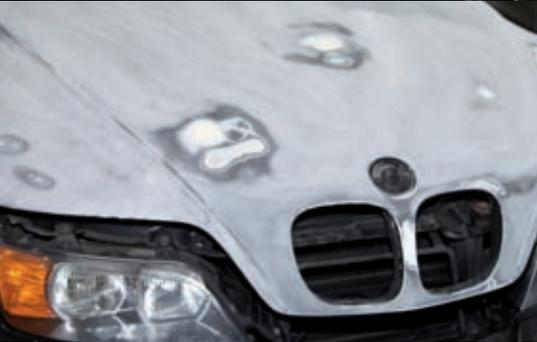
2) Der Schadensbereich wird ausgeschliffen und dünn gespachtelt.
