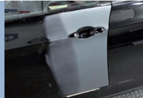
9) Füller wird grundsätzlich nur dort aufgetragen, wo er benötigt wird. Dies spart nicht nur Material sondern vermeidet hohe Lackschichtstärken.
